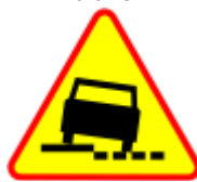
A-31 niebezpieczne pobocze
