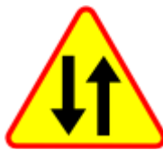
A-20 odcinek jezdni o ruchu dwukierunkowym
