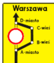
F-8 objazd w związku z zamknięciem drogi
