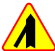
A-6e wlot drogi jednokierunkowej z lewej strony
