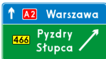
E-2c drogowskaz tablicowy umieszczony obok jezdni na autostradzie
