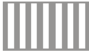
P- 10 przejście dla pieszych
