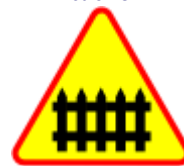
A-9 przejazd kolejowy z zaporami
