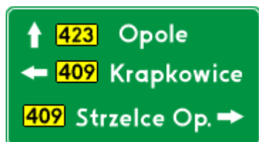
E-2a drogowskaz tablicowy umieszczony obok jezdni
